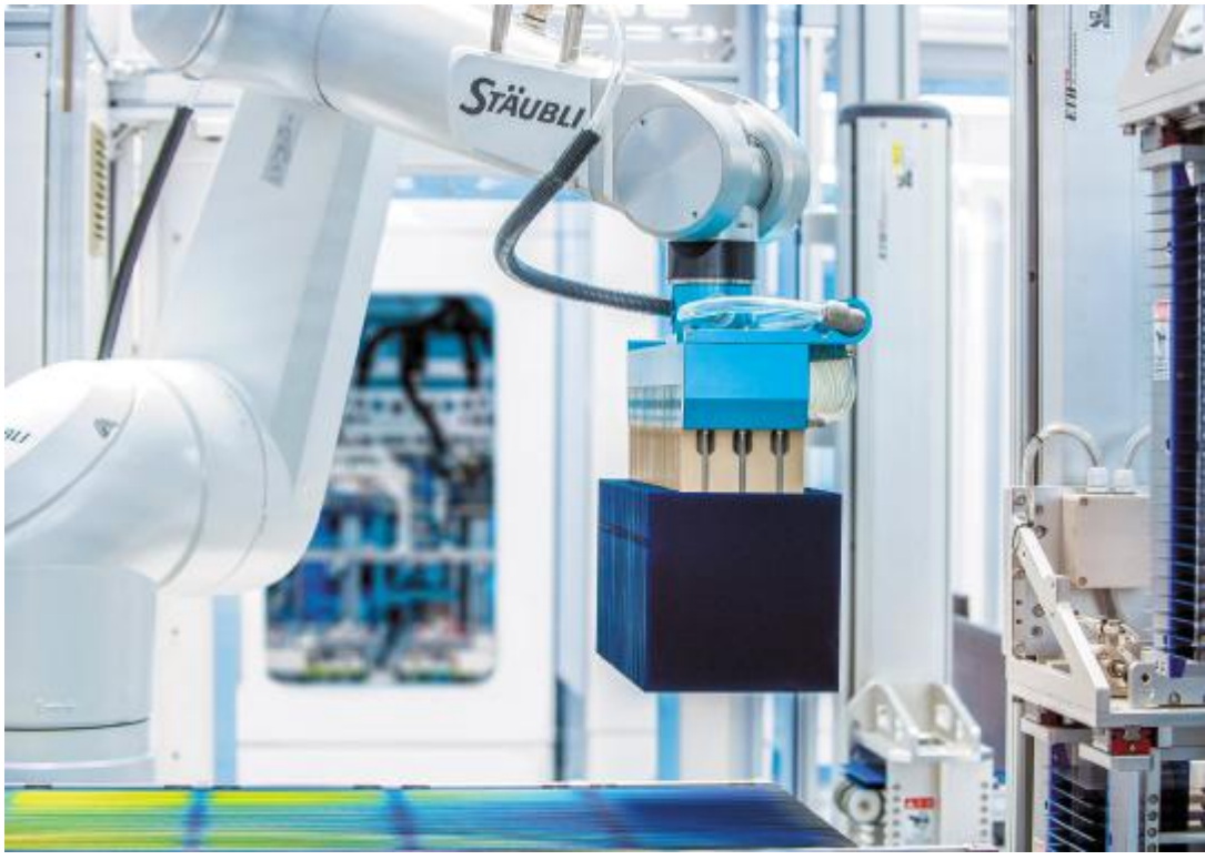
通威太阳能智能制造生产线机械臂取放片
